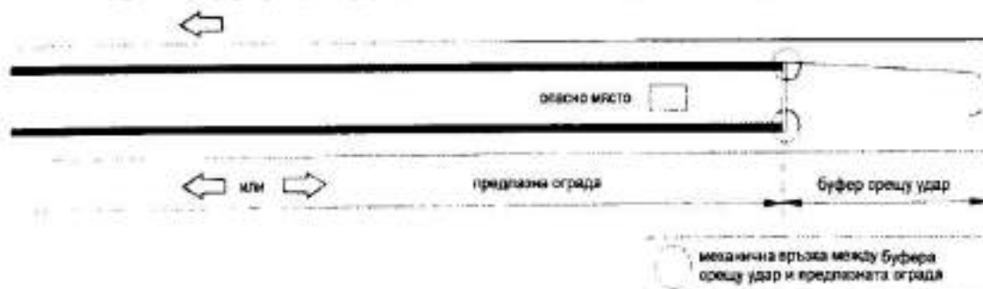
Фигура 18 Буфер срещу удар в началото на средна и странична ивица
