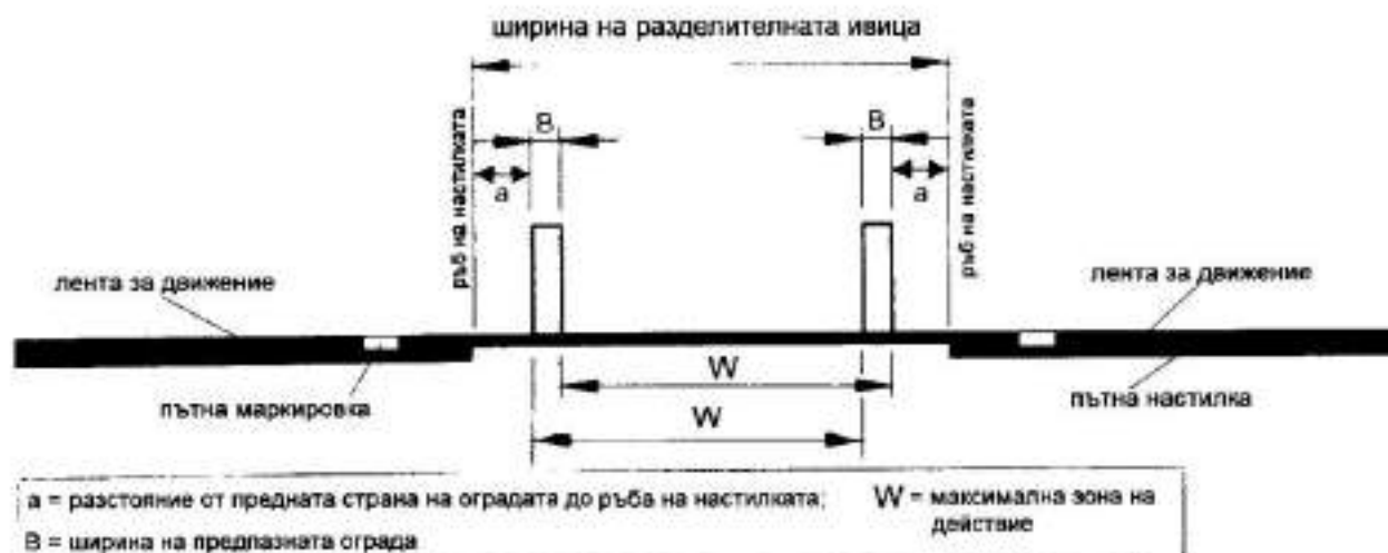
Фигура 16в Едностранна предпазна ограда с разделно действие в зоната на разделителната ивица, разположена до ръба на настилка
